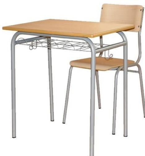
N.10 sedie struttura d'acciaio sez. mm.22\*1.5 verniciato a polveri epossidiche di colore marrone; sedile e spalliera anatomici stampati in legno faggio multistrati sp. Mm. 8 fissati al telaio con n. 4 rivetti da mm.5, due barre di collegamento in tubo d'acciaio
